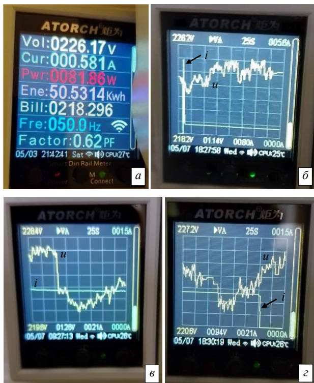
Рис. 5. Приклади вимірювання електричних параметрів холодильника та побудови графіків струму і напруги
