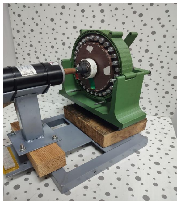
Рис. 6. Експериментальна установка для дослідження магнітної передачі в робочому режимі
