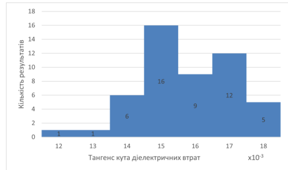
Рис. 17. Гістограма розподілу отриманих значень \text{tg}\delta AB при застосуванні схеми обстеження «дві жили проти третьої та оболонки»
