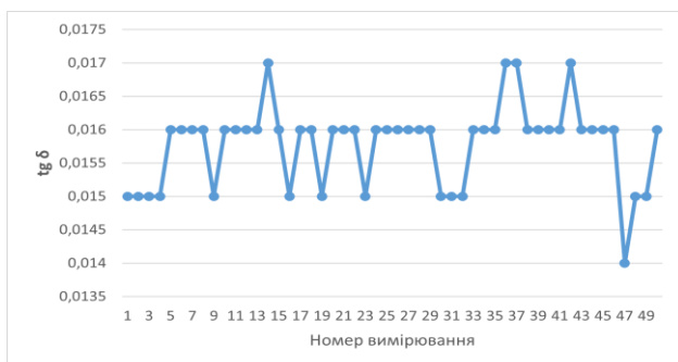
Рис. 7. Результати повторних вимірювань сукупних значень \text{tg}\delta_{ABC\_G} при застосуванні схеми обстеження: «оболонка проти трьох жил»
