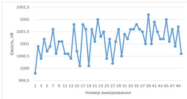
Рис. 6. Результати повторних вимірювань сукупних значень електричної ємності C_{ABC\_G} при застосуванні схеми обстеження: «оболонка проти трьох жил»
