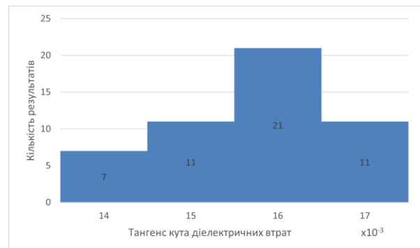
Рис. 19. Гістограма розподілу отриманих значень \text{tg}\delta AC при застосуванні схеми обстеження «дві жили проти третьої та оболонки»
