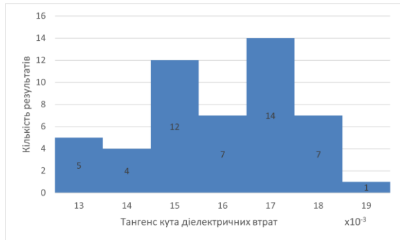
Рис. 13. Гістограма розподілу отриманих значень \text{tg}\delta C при застосуванні схеми обстеження «жила проти двох інших та оболонки»
