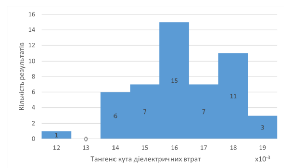
Рис. 11. Гістограма розподілу отриманих значень \text{tg}\delta_A при застосуванні схеми обстеження: «жила проти двох інших та оболонки»
