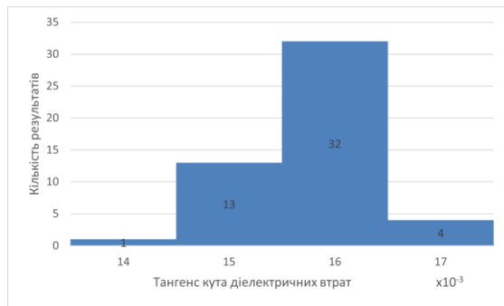
Рис. 21. Гістограма розподілу отриманих значень \text{tg}\delta ABC G при застосуванні схеми обстеження «оболонка проти трьох жил»
