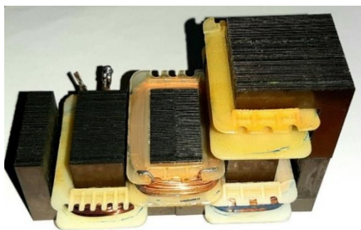
Рис. 4. Фізична модель індуктора і статора з секцією
