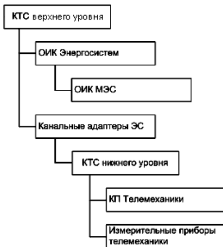
Рис. 1 – Структурная схема передачи данных телемеханики
