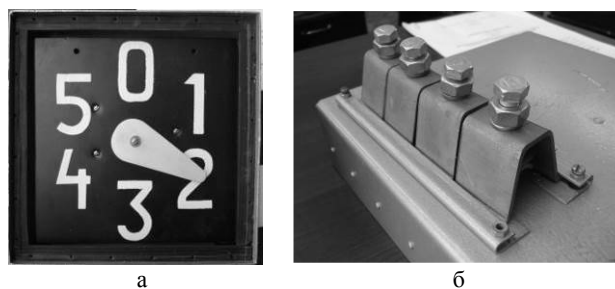
Рис. 1 – Фіксатор короткого замикання: а – циферблат; б – зовнішня частина магнітної системи
