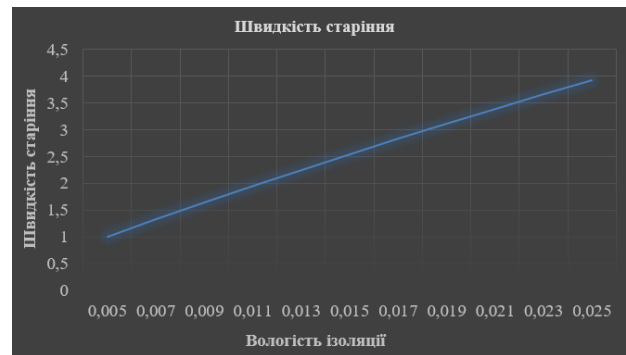
Рис. 12. Графік залежності прискорення процесу старіння від вологості ізоляції
