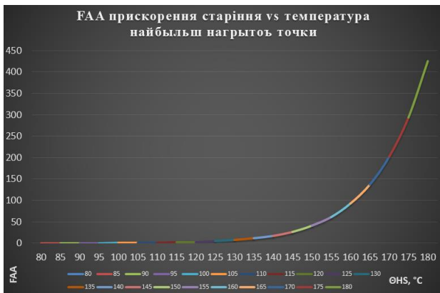
Рис. 10. Графік залежності прискорення процесу старіння від температури найбільш нагрітої точки в макротріщині
