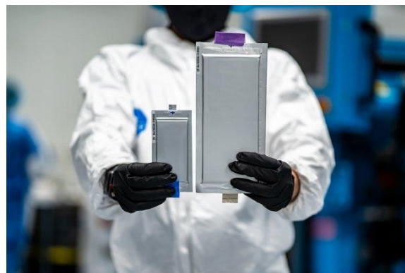
Рис. 5. Зліва кремнієвий, праворуч літій-іонний акумулятор
