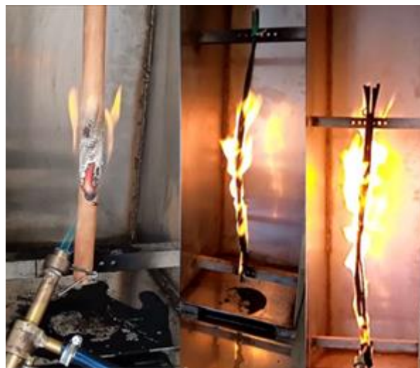
Рис. 2. Приклад випробування на вертикальне поширення полум'я одиночного кабелю (IEC/EN 60332-1-2).
